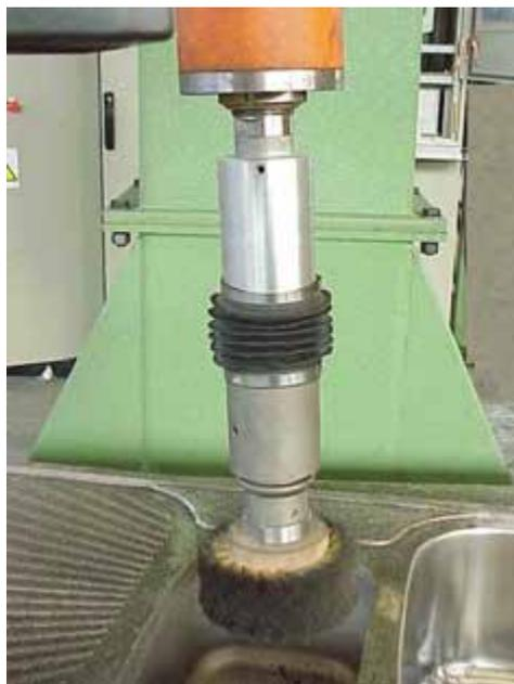
L'unità di lavoro tipo 277P nella posizione 2 è equipaggiato con una testa portautensile a due mandrini sui quali si montano un utensile (spazzola a fungo) per la lavorazione della fascetta della vasca ed un utensile (spazzola cilindrica) per la lavorazione della parete della vasca.
