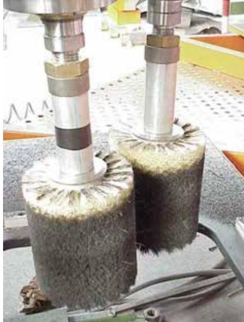
Le unità di lavoro tipo 233F-277F nelle relative posizioni 3-4-6 sono equipaggiate con una testa portautensile a singolo mandrino sul quale si monta un utensile (spazzola a fungo) per la lavorazione del fondo (fascetta) della vasca.
