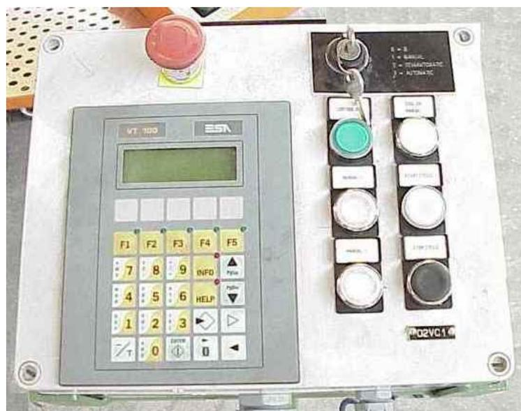
Ogni unità di lavoro è dotata di connessione che permette di collegare la pulsantiera mobile di comando. La pulsantiera mobile si può collegare solo nel modo di funzionamento Manuale con le porte della cabina escluse. Con la pulsantiera mobile collegata a una unità di lavoro è possibile movimentare solo l'unità collegata.
